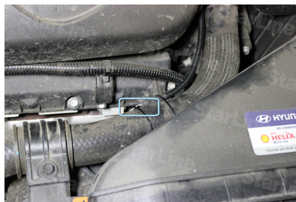
Фото 4.2. Датчик температуры двигателя
