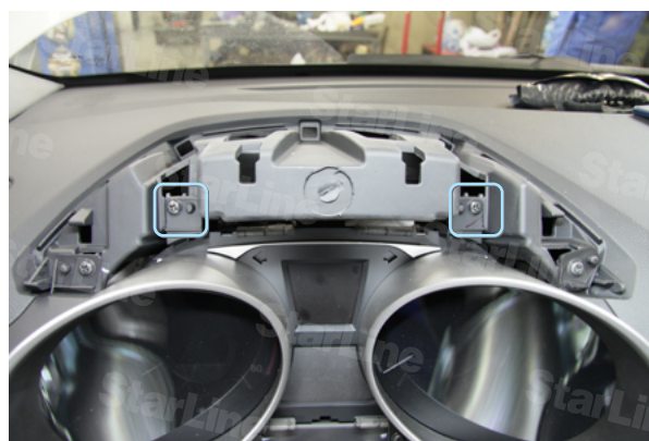
Фото 3.4. Козырек снят, саморезы щитка приборов
