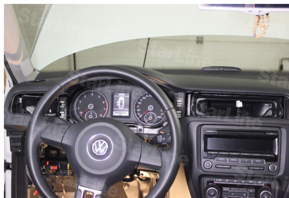
Фото 3.2. Накладка панели приборов снята
