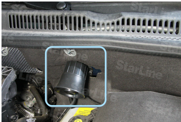
Фото 5.1. Сирена (крепление на болт М6)
