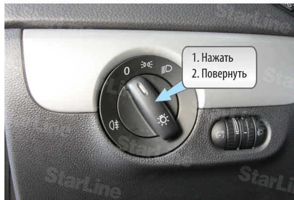
Фото 1.2. Снятие выключателя света
