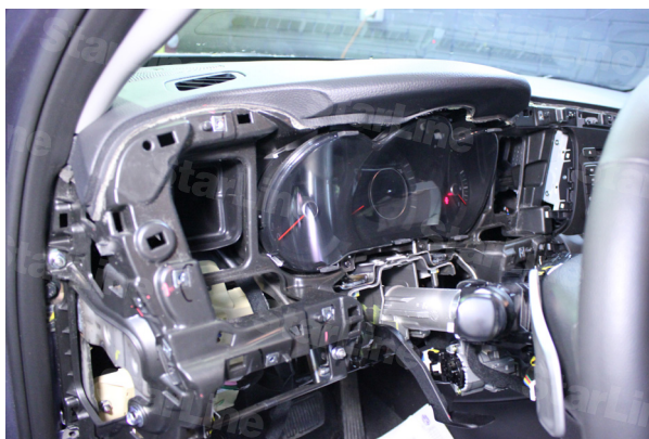
Фото 3.5. Центральная накладка панели приборов снята
