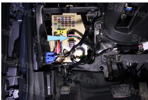
Фото 11.3. Местоположение разъема контроля стояночного тормоза
