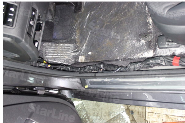
Фото 1.4. Накладка порога и кик-панели снята
