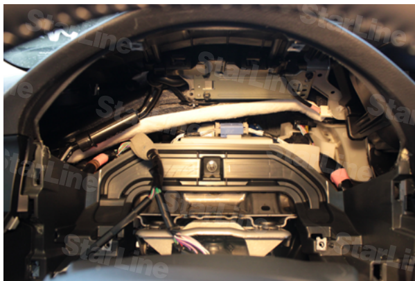
Фото 2.3. Щиток приборов снят
