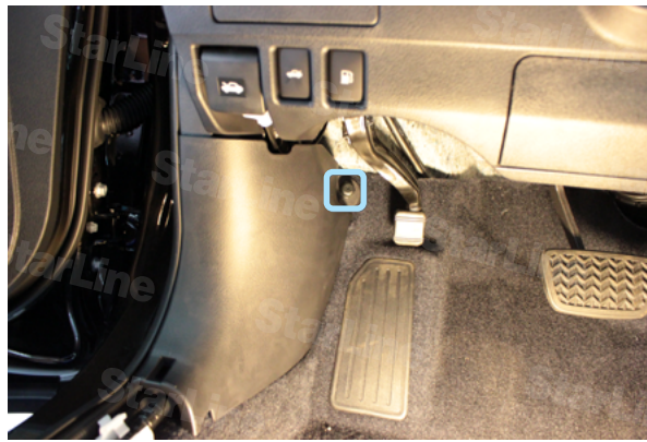
Фото 1.2. Накладка порога снята; поворотная клипса
