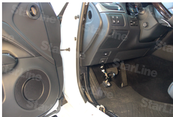
Фото 1.4. Вертикальная накладка снята
