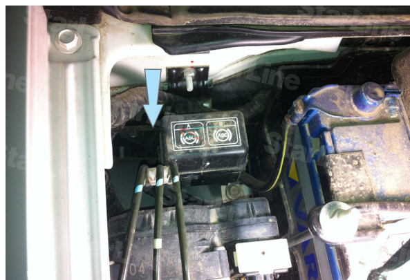
Фото 4.4 Штатный уплотнитель (за блоком реле с правой стороны моторного щита)
