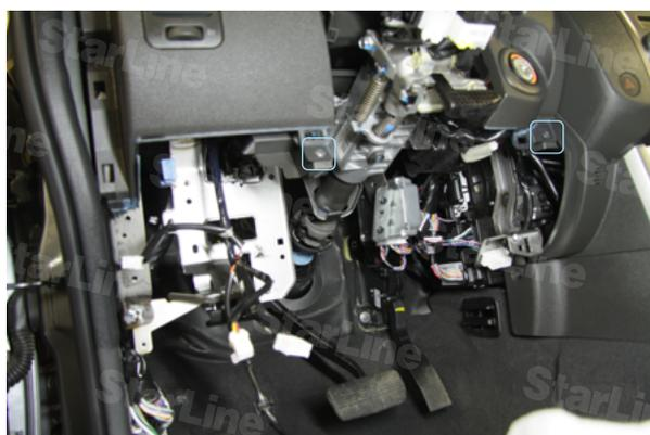
Фото 3.3. Саморезы крепления накладки панели приборов
