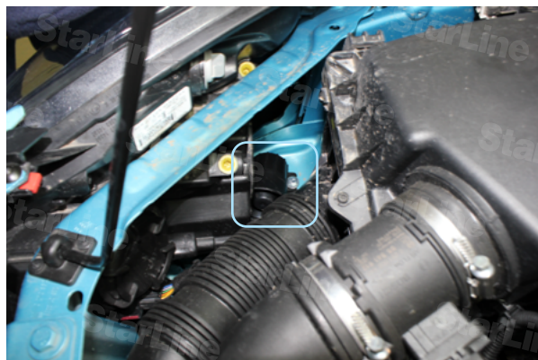
Фото 2.1. Сирена (крепление на болт с гайкой М6 в штатное отверстие)
