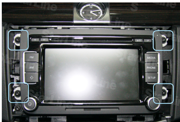
Фото 2.3. Саморезы крепления магнитолы
