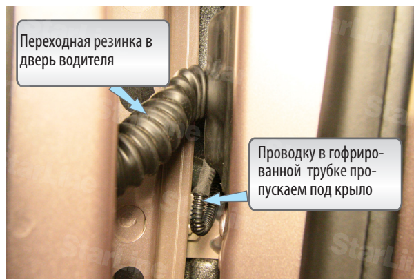
Фото 4.3. Прокладка жгута в подкапотное пространство через крыло
