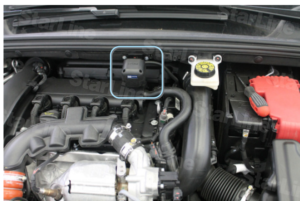
Фото 5.1. Сирена (крепление на 2 самореза)
