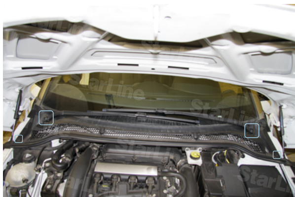
Фото 4.1. Гайки крепления поводков и саморезы накладки
