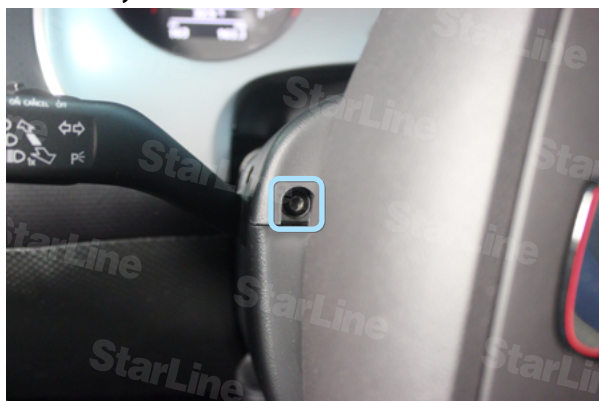
Фото 1.1. Саморез рулевого кожуха
