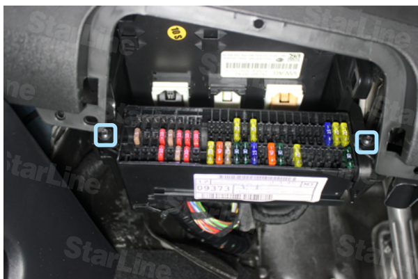
Фото 3.3. Винты блока предохранителей
