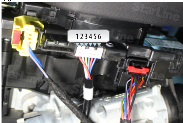
Фото 10.1. Внешний вид разъема замка зажигания (нумерация пинов)
