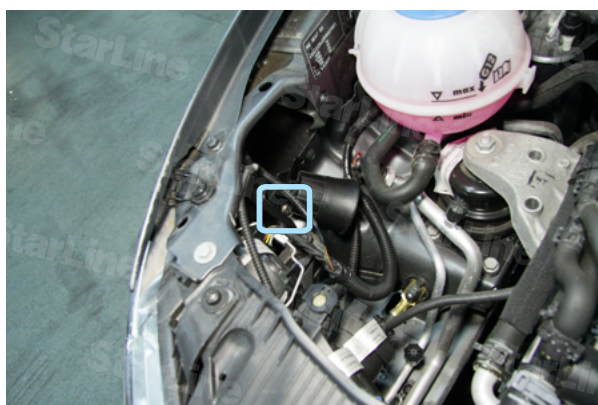
Фото 5.1. Сирена (крепление на болт М6 с гайкой)
