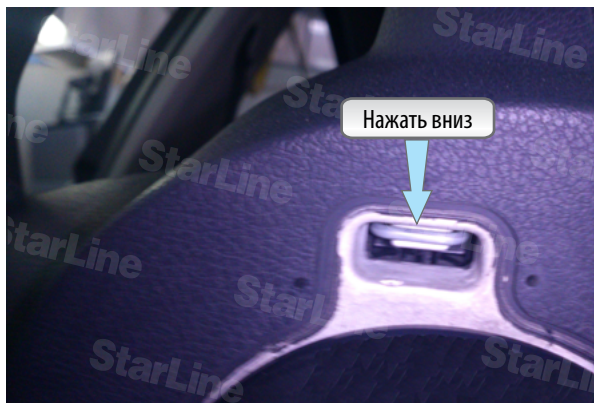
Фото 2.2. Пружина крепления подушки безопасности
