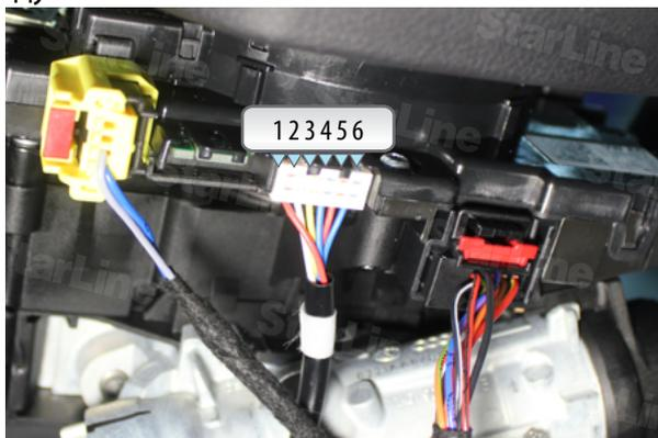
Фото 9.1. Внешний вид разъема замка зажигания (нумерация пинов)
