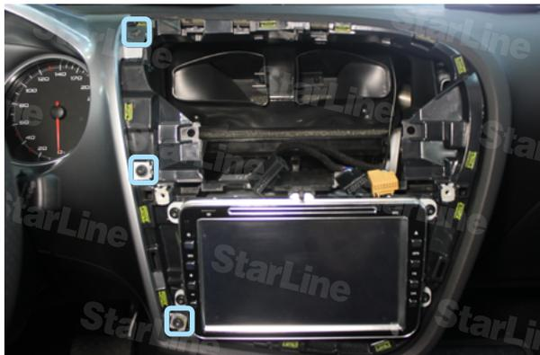
Фото 2.3. Накладка с панелью управления климат-контролем снята; саморезы
