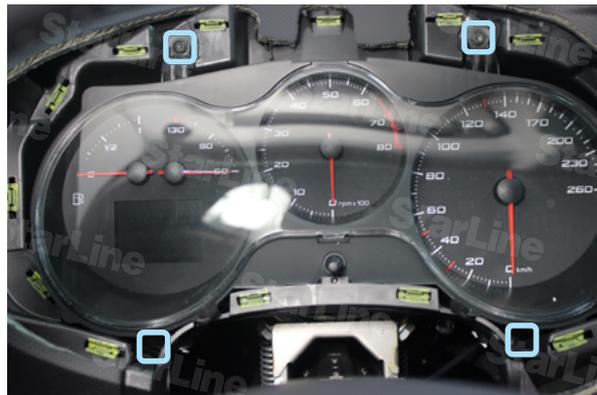
Фото 2.4. Накладка щитка приборов снята; саморезы
