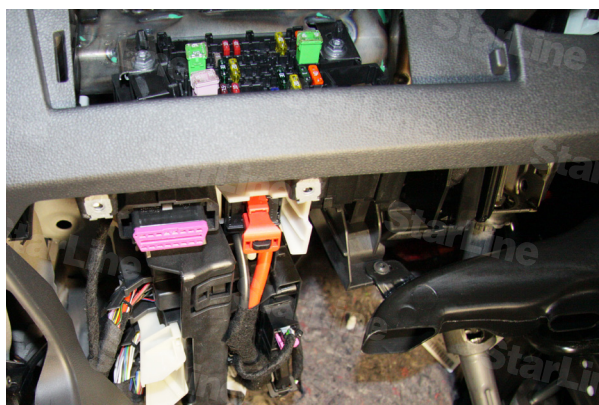
Фото 1.5. Накладка подторпедника снята
