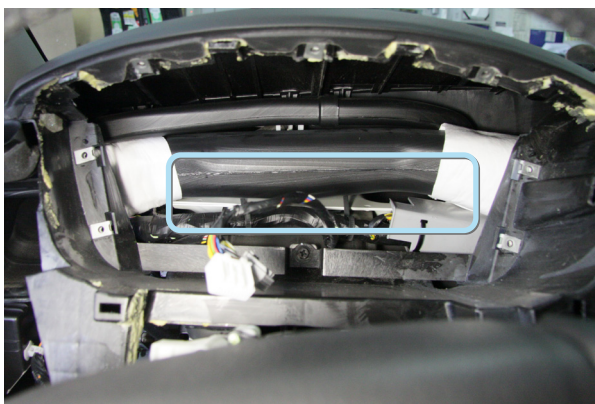
Фото 6. Место установки блока сигнализации
