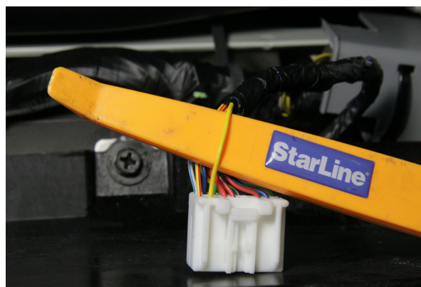
Фото 10.2. Провод контрольной лампы зарядки (желтый pin2)
