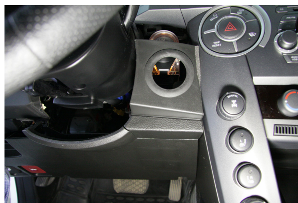
Фото 1.4. Демонтаж правой части подторпедника
