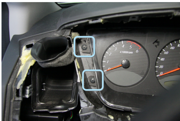
Фото 3.1. Саморезы крепления накладки панели приборов
