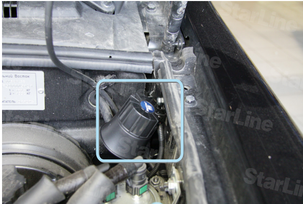
Фото 5.1. Сирена (крепление на штатное отверстие)
