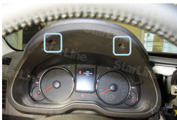
Фото 2.5. Саморезы крепления накладки панели приборов
