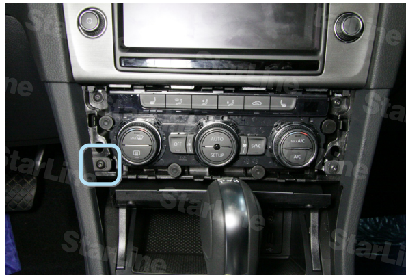
Фото 1.2. Саморезы крепления боковой накладки центральной консоли
