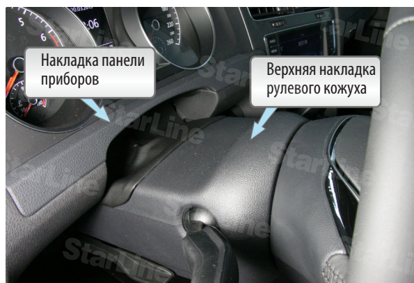
Фото 2.2. Верхняя накладка рулевого кожуха и накладка панели приборов.
