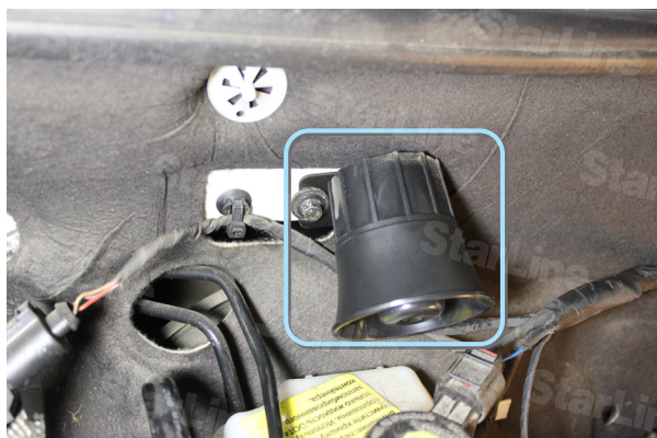
Фото 4.1. Сирена (крепление на болт М6)
