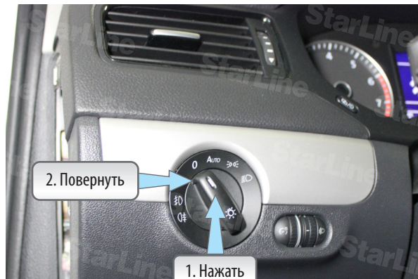
Фото 1.2. Снятие выключателя света
